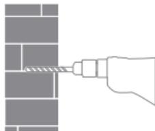
2. 将四个塑料膨胀螺母钉入墙壁。
