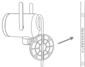
4. 上墙底座贴于墙面上，保持电源线接口向下，将螺钉穿入孔内，并拧入墙上的膨胀螺母中。
